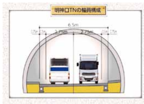
◀ トンネル完成時の幅員構成図
