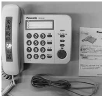
▲非常用電話機(送信用)
